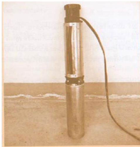
รูปที่ 31 เครื่องสูบน้ำบาดาลซับเมอร์ซิเบิล (Submersible Pump)
